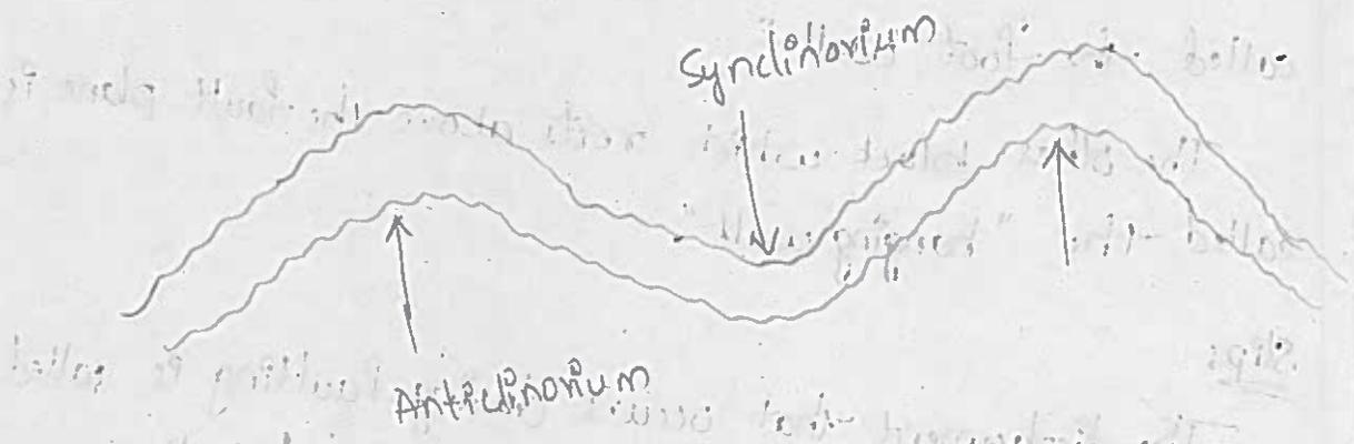
fig: Anticlinorium & synclinorium
